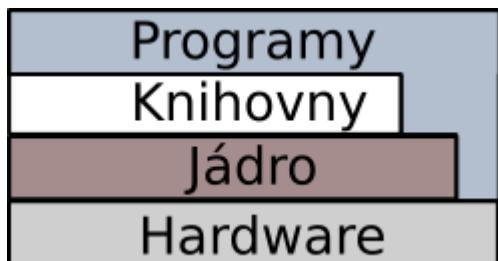
Jak vidíte na obrázku, většina programů volá různé funkce knihoven, které se potom předávají jádru. Nicméně některé programy potřebují přistupovat k jádru přímo pomocí jeho systémových volání. A existuje i skupina programů, která vyžaduje přímý přístup k hardwaru (typicky X server). Takové programy musí běžet s právy roota.
